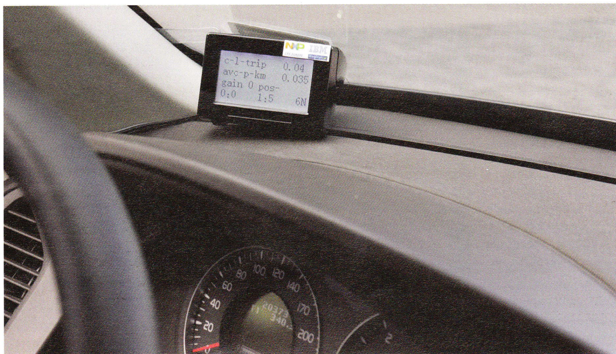
Frank Daems (NXP): "Het toestelletje op het dashboard is verbonden met een vignet waarin een chip is ingebouwd. Dat kleef je aan de voorruit. Je kan het niet verwijderen zonder het stuk te maken. Het vignet is eigenlijk de identiteitskaart van de auto, daarop staan alle eigenschappen van de wagen."
