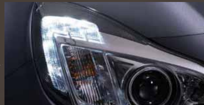
LED-dagrijverlichting. Trekt de aandacht van andere weggebruikers zonder meer brandstof te verbruiken (niet zoals de lage lichtbundel).
