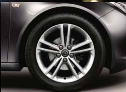
❻ Lichtmetalen velg, 8 J x 18, 5 dubbele spaken, bandenmaat 245/45 R 18 (Q02).
