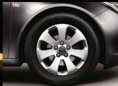
❹ Lichtmetalen velg, 7 J x 17, 7 spaken, bandenmaat 225/55 R 17 (Q00).
