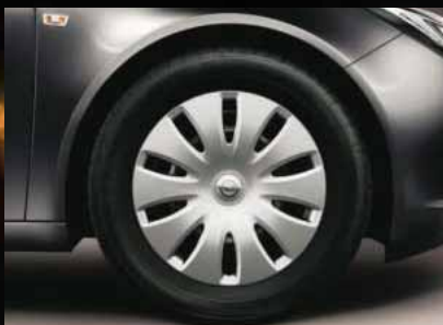
❷ Stalen velg met wioldop, 7 J x 17, 10 spaken, bandenmaat 225/55 R 17 (QR4).
