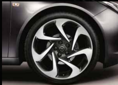
14 Lichtmetalen designvelg, 8,5J x 20, 7 spaken, bandenmaat 245/35 R 20 (Q7R).
