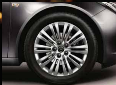
❼ Lichtmetalen velg, 8 J x 18, 10 dubbele spaken, bandenmaat 245/45 R 18 (RT4).
