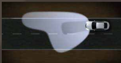
Slecht-weer-verlichting (tot 70 km/u). Het licht levert een betere zichtbaarheid bij slechte weersomstandigheden en wordt geactiveerd wanneer de ruitenwissers ingeschakeld worden of de regensensor regen waarneemt.
