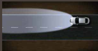
Grootlichtassistent (boven 40km/u). Schakelt automatisch tussen hoge en lage lichtbundels door naderende (al dan niet tegenliggende) wagens te detecteren. Functie vervalt in combinatie met Opel Eye.
