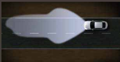
Snelwegverlichting (meer dan 115 km/u). 140 meter bereik, hoger en helderder dan de normale, lage lichtbundels, zonder andere automobilisten te verblinden.
