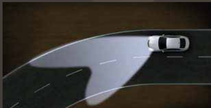
Dynamische bochtverlichting (elke snelheid). Volgens de stuurhoek en de snelheid zwenken de lampen in de bocht tot 15 graden naar links of rechts.
