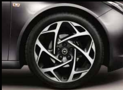
⓬ Lichtmetalen velg, 8,5 J x 19, 6 spaken, bandenmaat 245/40 R 19 (Q7P).
